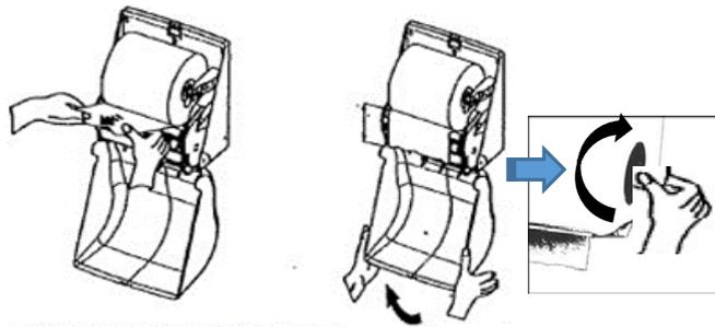
3. & 4. Maintenir le papier en pressant légèrement entre les 2 rouleaux d'entraînement et tourner la molette latérale 1 à 2 fois pour enclencher le mécanisme et amorcer la feuille de papier dans l'appareil.
