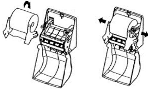
1. & 2. Positionner la bobine de sorte que le papier se déroule par l'arrière, mettre en place les 2 porte-bobine à l'intérieur du madrin, dérouler manuellement la feuille et la positionner, devant le mécanisme.
