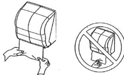
5. Refermer l'appareil, le distributeur est prêt à fonctionner. Tirer le papier vers le bas en utilisant les 2 mains. Le distributeur découpe le papier automatiquement tout les 27 cm.
